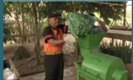
3. Sampah Organik dicacah menggunakan mesin pencacah
